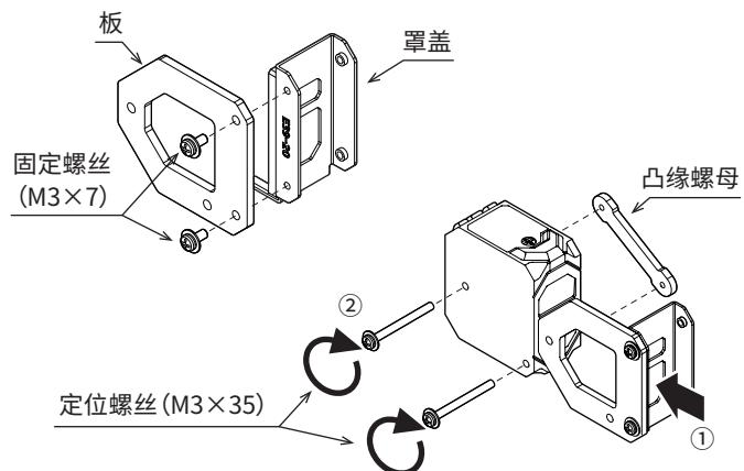
2. 请将保护罩保持在与E3AS-HF的基准面接触的状态下进行螺丝固定。
